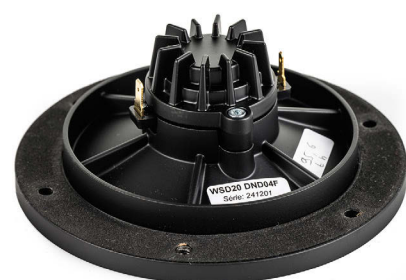
Tweeter jest autorską konstrukcją Atohma. Legitymuje się bardzo dużą efektywnością (97 dB). Tekstylna kopułka ma mniejszą niż zwykle średnicę (20 mm). Napęd neodymowy. To naprawdę świetny głośnik.
