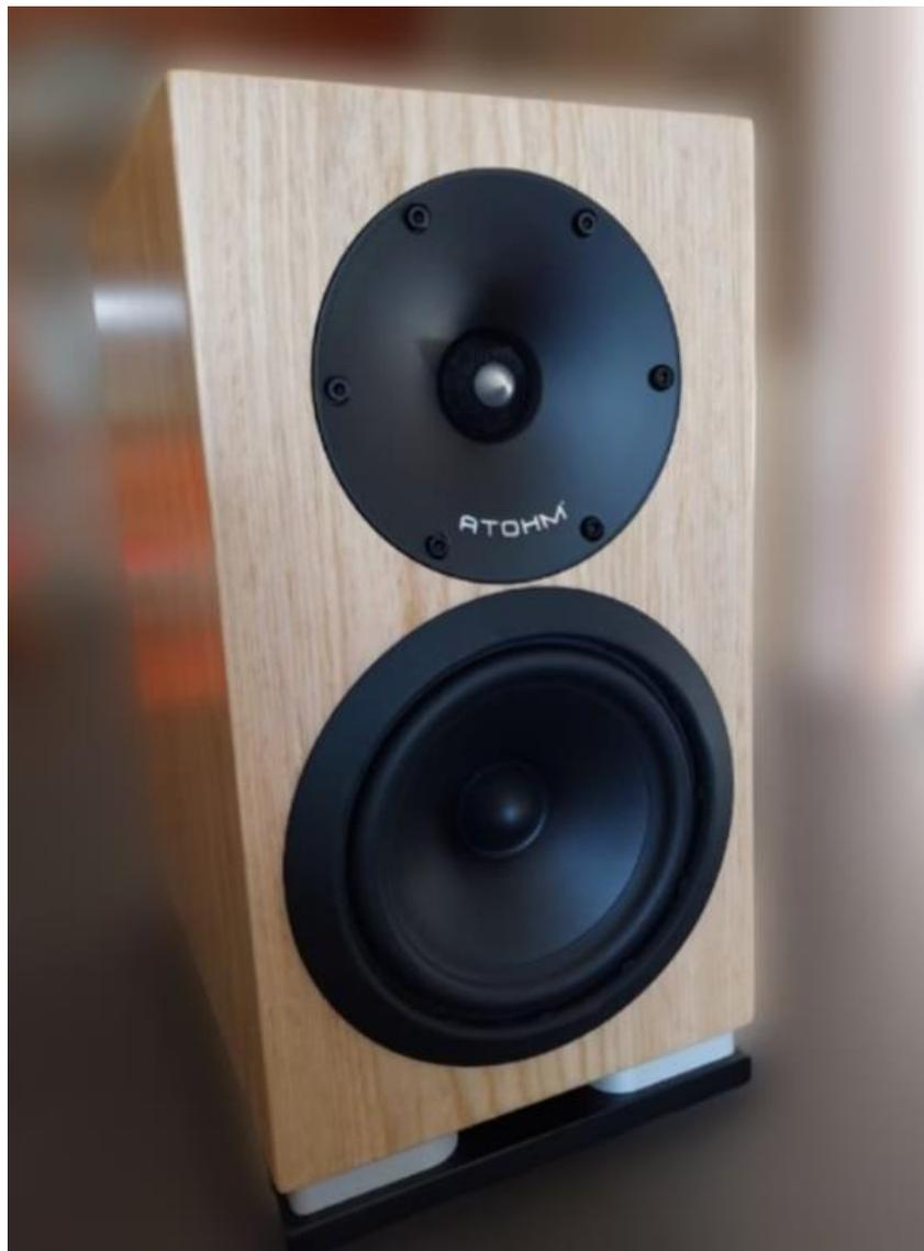
L'ébénisterie est constituée de panneaux en MDF de 18 millimètres d'épaisseur recouverte d'un sublime placage – ici en chêne clair – parfaitement ajusté. Ce coffret repose sur une plaque également en MDF. Celle-ci est découplée du coffret par 4 entretoises en aluminium. Cette disposition est prévue afin que les événements puissent évacuer efficacement la compression des flux générés par les haut-parleurs.
