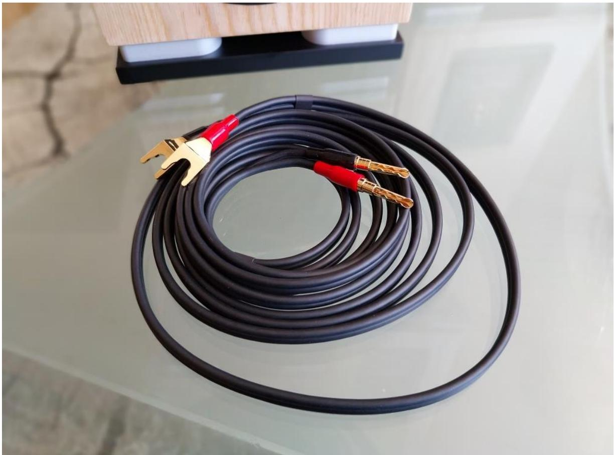
Ce câble est réalisé à partir d'une structure conductrice similaire à celle du ZEF SPEAKER (1 monobrin de cuivre OCC / toron cuivre UC-OFC argenté). D'une section de 2,5 mm<sup>2</sup>, ce câble se compose d'une structure centrale mono brin en cuivre monocristallin OCC entourée par un toron périphérique composé de 204 brins en cuivre UC-OFC plaqué Argent. L'ensemble est placé au sein d'une gaine en PVC très souple.
