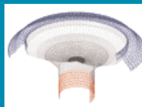
Etude du fractionnement de la membrane et des suspensions (modélisation 3D). Visualisation des déformations en dynamique (image virtuelle animée).
