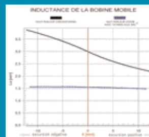
Variation de l'inductance en fonction des déplacements de la bobine (courbe plate : H.P. Atohm "DRC").
