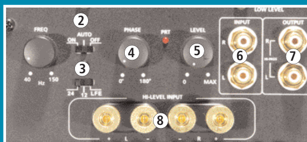
Arrière du caisson. 1 - Réglage de la fréquence de coupure haute (filtre) en continu entre 40 et 150 Hz. 2 - Mode de fonctionnement : On (marche permanente), Auto (marche en la présence d'un signal, passage en standby en l'absence de signal), Off (mode standby). 3 - Choix de la pente du filtre (12 ou 24 dB par octave) ou mode "LFE" sans filtrage (le processeur audio vidéo contrôle la coupure du caisson). 4 - Réglage de la phase en continu entre 0 et 180°. 5 - Réglage du niveau. 6 - Entrées bas niveau. 7 - Sorties bas niveau avec filtrage actif passe-haut (coupure du grave à 50 Hz pour alimenter un ampli de puissance relié à des petites enceintes). 8 - Entrées haut niveau (sorties haut-parleurs d'un amplificateur).
