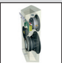
2 Vue 3D transparente d'une Furtive 1.0. La profondeur de l'enceinte arrive tout juste à loger l'aimant du 13 centimètres.
