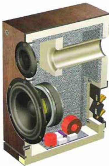
Cette vue éclatée montre le renfort interne de l'enceinte au niveau de l'évent et le revêtement amortissant sur toutes les parois. L'épaisseur du bois et les dimensions compactes assurent une très grande rigidité à la Sirocco 1.0.
