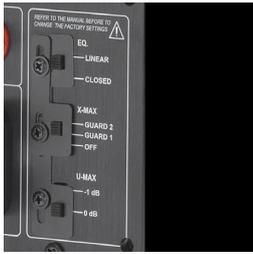
Les caissons de grave en charge close de faible volume nécessitent une égalisation adaptée afin d'explorer convenablement le registre infra grave. Un simple « boost » centré une fréquence ne peut convenir. Les modules S500 et S250 sont dotés d'une égalisation de type « shelving low pass » 2<sup>ème</sup> ordre ( position « closed » sur la façade) . Ce
