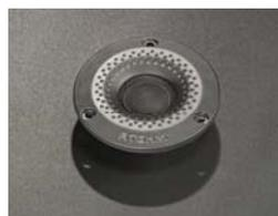
Le SD20ND04F (1) est un tweeter équipé d'un dôme en soie traitée de 20mm de diamètre, d'un moteur néodyme et d'une façade au profil spécifique en aluminium bénéficiant de la technologie ADP™ (*Anamorphic Dispersion Pattern*) garante d'une diffusion homogène jusqu'aux très hautes fréquences.
