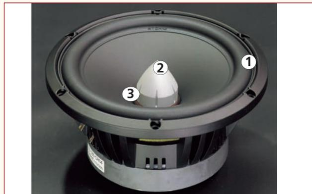
Le haut-parleur grave-médium LD180CR04 bénéficie d'une suspension (1) de technologie LDS à faible diffraction, d'un cône central fixe (2) en aluminium avec canaux radiaux (3), d'un noyau central bagué cuivre et d'un profil de plaque de champ pour diminution des courants de Foucault.
