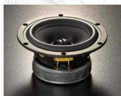
Le LD130CR04 (2) est doté d'une belle motorisation, d'une membrane papier à suspension périphérique LDS™ (*Low Diffraction Surrounding*) et d'un noyau bague cuivre réduisant sensiblement la distorsion et la valeur inductive de la bobine mobile.
